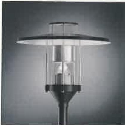
Von der Zufahrt durch das östlichste Tor gibt es Beleuchtung durch **Mastleuchten von Trilux**, die bereits im Stadtbild anzutreffen sind. Die Optik besteht aus einem rotationssymmetrischen Spiegelreflektor mit integriertem LED-Modul, das in der Lichtfarbe warmweiß, Farbtemperatur 3000 K mit einem Gesamtlichtstrom von 2000 lm arbeitet.
